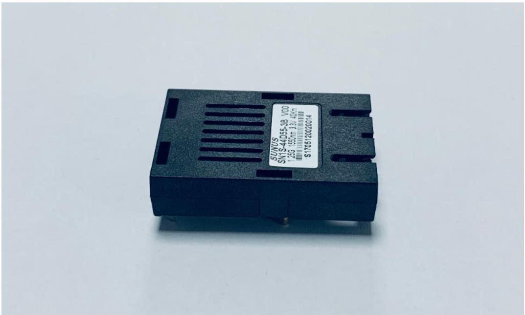
工业级光模块对其中的光板起到一定的保护作用，使用时可以将信号引入到光板之中去处理，此外，工业级光模块生产厂家制造处理的工业级光模块还能够让光板更好的去适应不同的光接口，因此，可以有效避免直
